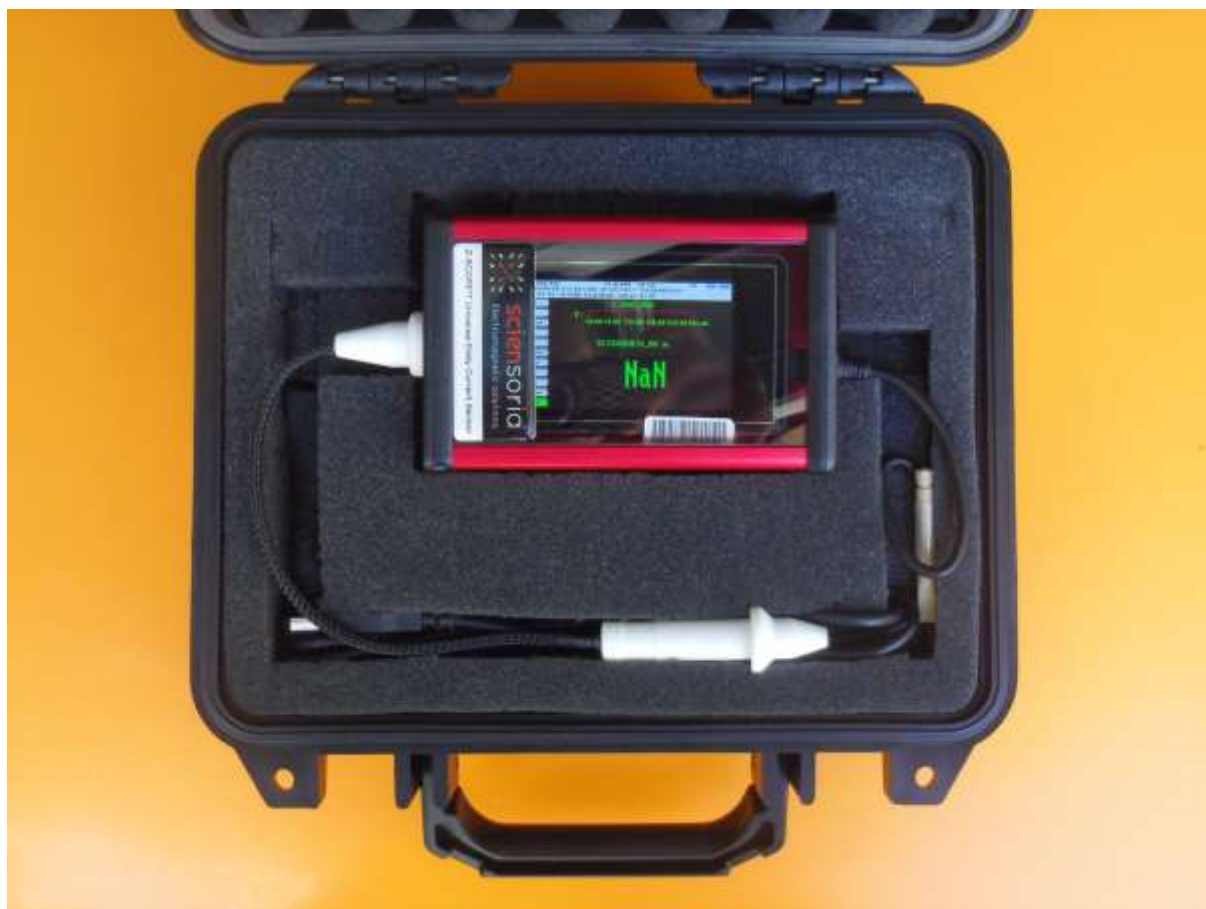
Figure 1 - Contenu de la livraison : (1) Appareil Z-Scope*7, (2) Sonde à courants de Foucault, (3) Câble USB
